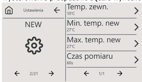
Rys. 25 Ekran ustawień nagrzewnicy elektrycznej wstępnej
