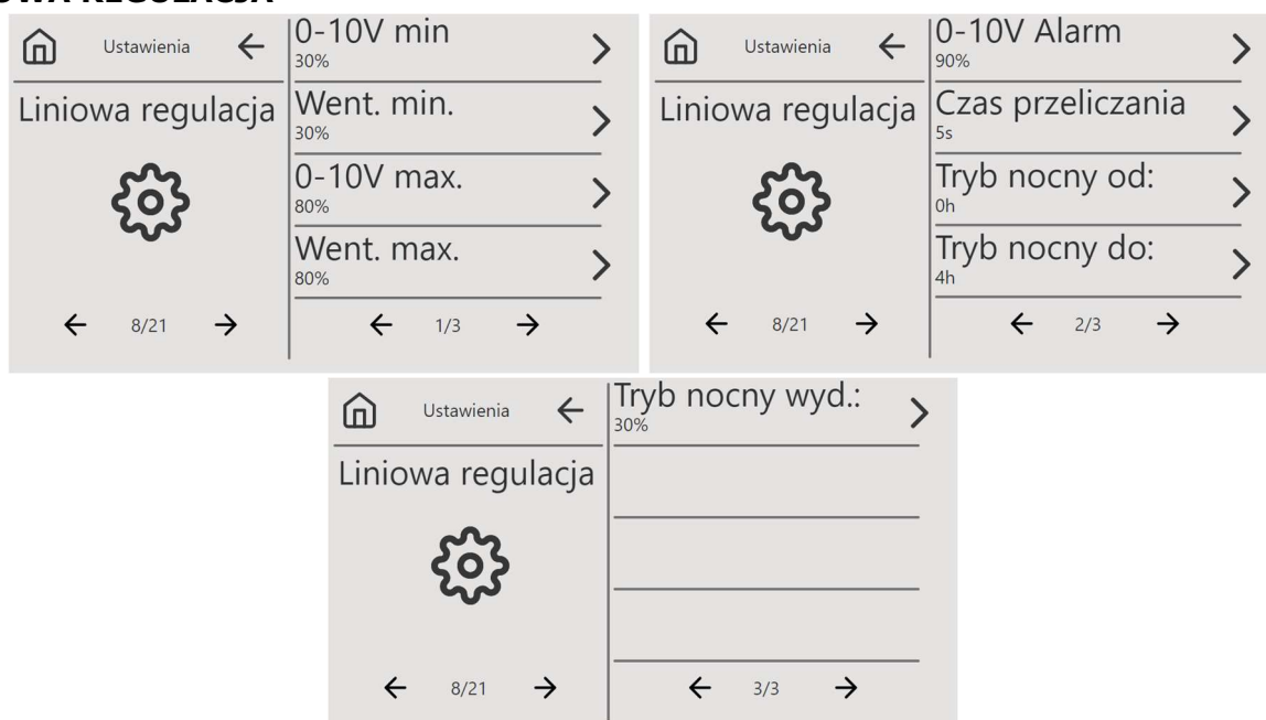
Rys. 35 Ekrany ustawień parametrów linowej regulacji
