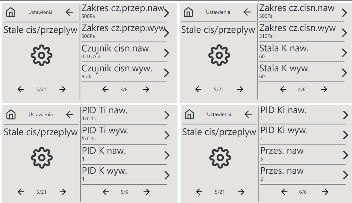
Rys. 28 Ekran ustawień parametrów stałego przepływu / stałego ciśnienia
