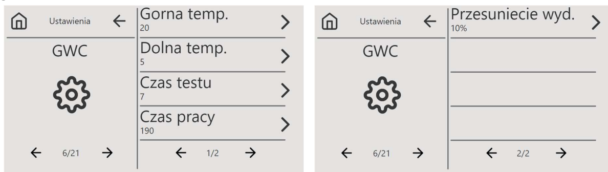
Rys. 29 Ekran ustawień parametrów gruntowego wymiennika ciepła
