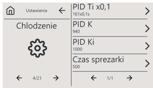
Rys. 27 Ekran ustawień parametrów chłodzenia
