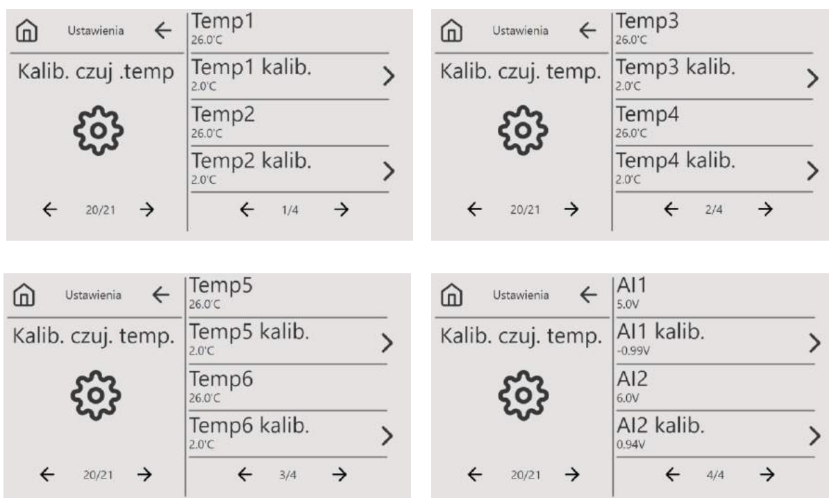
Rys. 41 Ekrany kalibracji czujników
