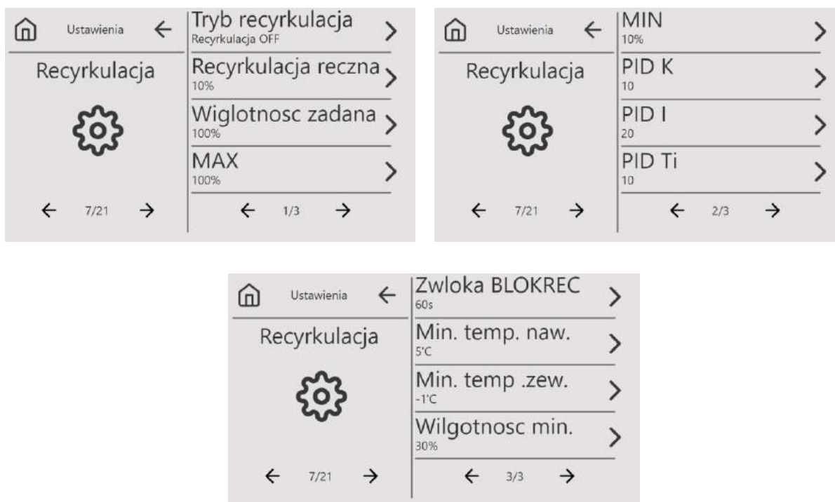
Rys. 28 Ekrany ustawień parametrów recykulacji
