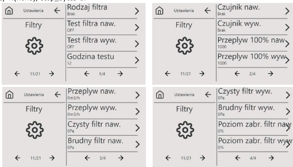
Rys. 32 Ekran ustawień parametrów filtrów powietrza
