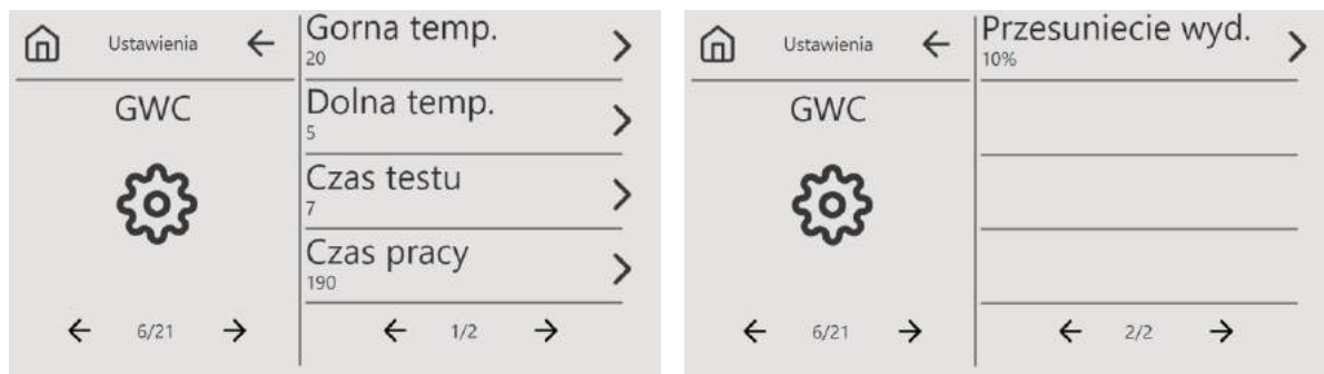
Rys. 27 Ekrany ustawień parametrów gruntowego wymiennika ciepła
