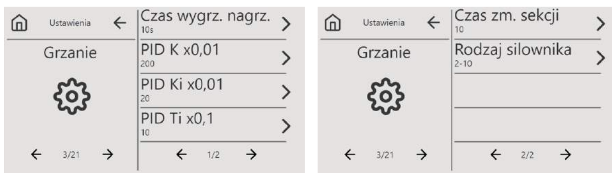
Rys. 24 Ekran ustawień parametrów grzania
