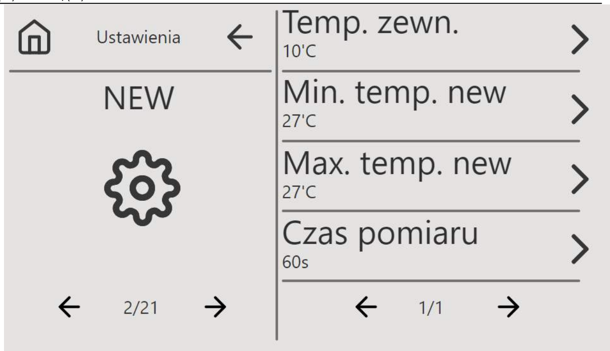
Rys. 23 Ekran ustawień nagrzewnicy elektrycznej wstępnej
