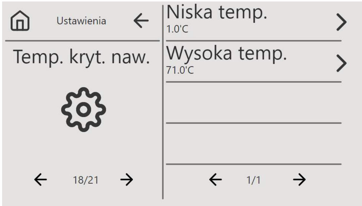
Rys. 39 Ekran ustawień krytycznej temp. nawiewu
