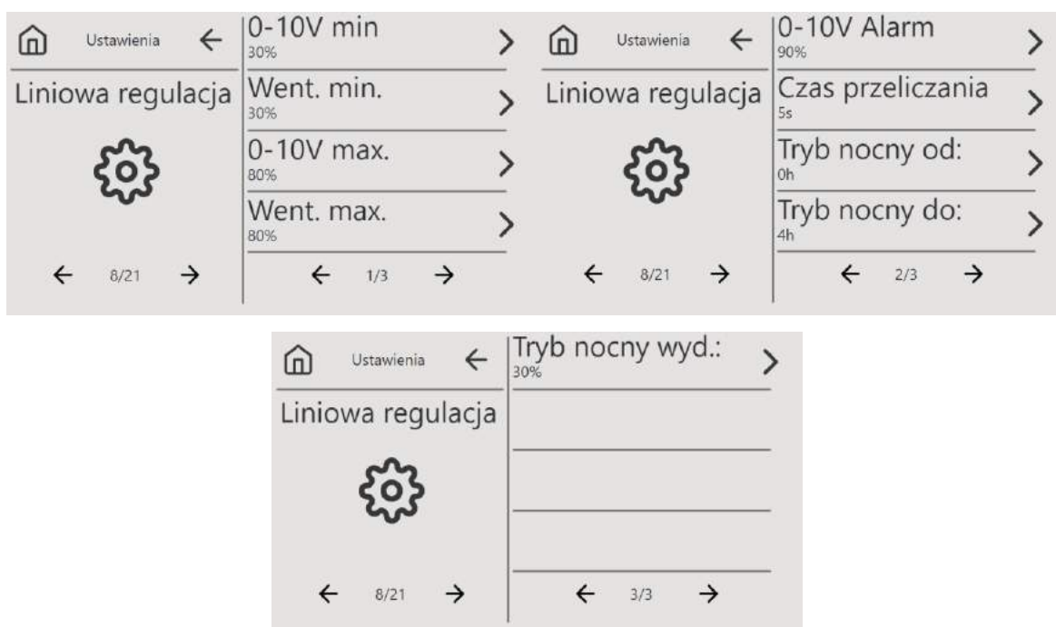
Rys. 29 Ekrany ustawień parametrów linowej regulacji
