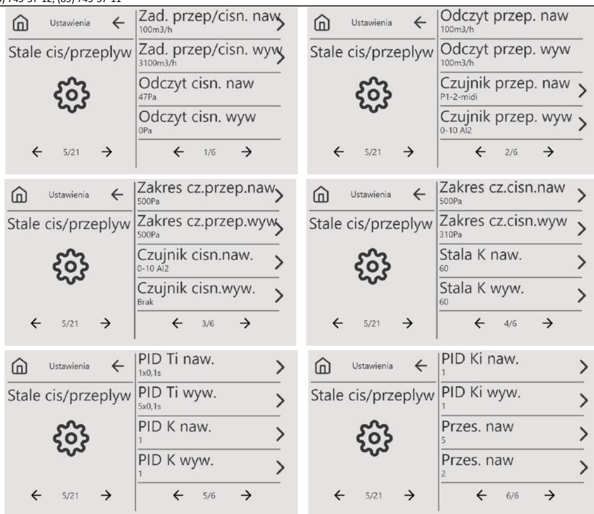
Rys. 26 Ekrany ustawień parametrów stałego przepływu / stałego ciśnienia
