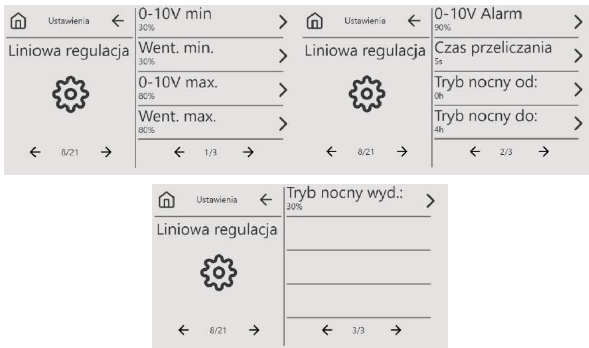
Rys. 35 Ekrany ustawień parametrów linowej regulacji
