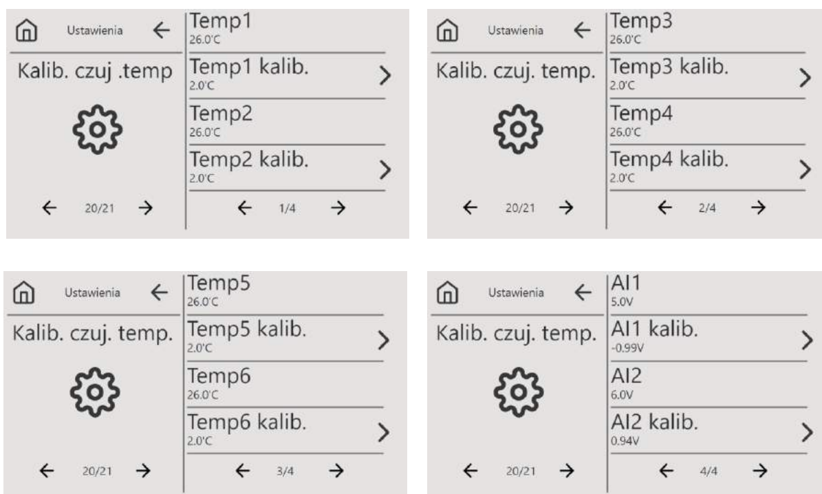
Rys. 43 Ekrany kalibracji czujników
