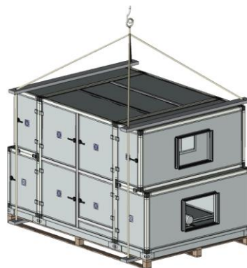
Rys. 3 Prawidłowy transport pionowy z użyciem dźwigu i belek transportowych i rozporowych
