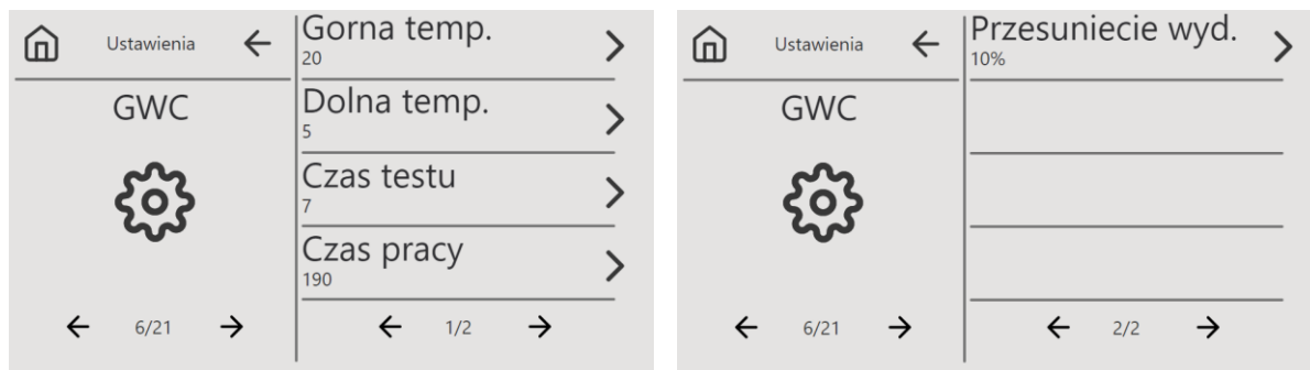
Rys. 29 Ekrany ustawień parametrów gruntowego wymiennika ciepła
