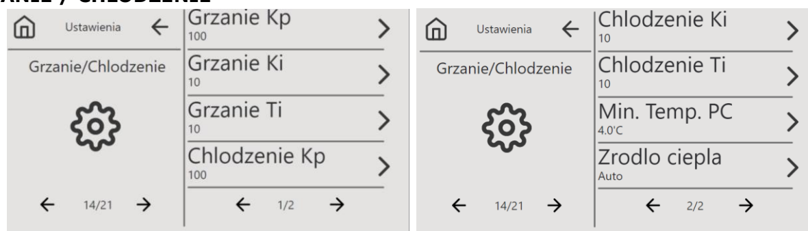
Rys. 37 Ekrany ustawień Grzanie/Chłodzenie
