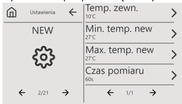
Rys. 25 Ekran ustawień nagrzewnicy elektrycznej wstępnej
