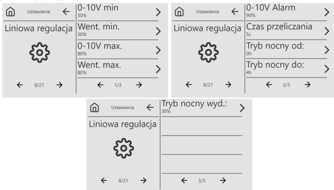
Rys. 35 Ekrany ustawień parametrów linowej regulacji
