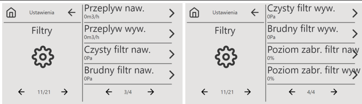
Rys. 35 Ekrany ustawień parametrów filtrów powietrza
