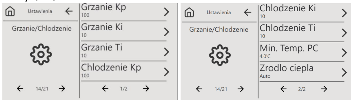
Rys. 35 Ekrany ustawień Grzanie/Chłodzenie
