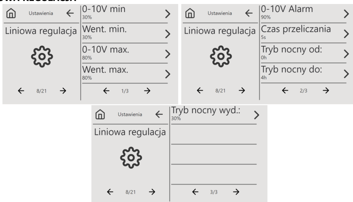
Rys. 29 Ekrany ustawień parametrów linowej regulacji
