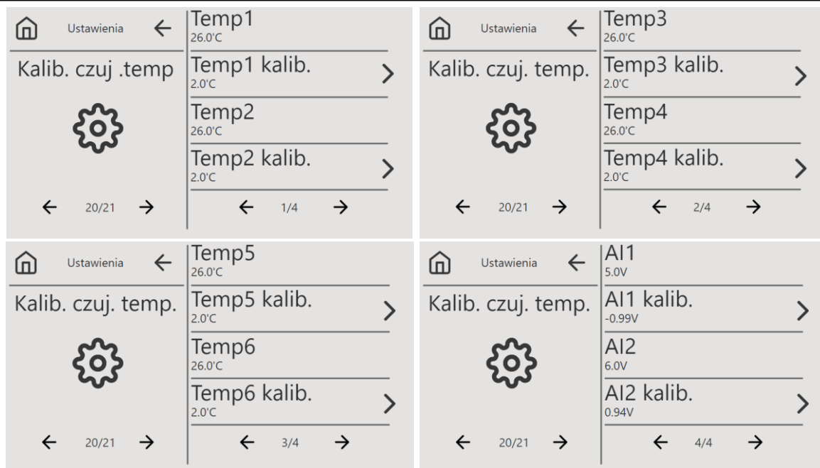
Rys. 41 Ekrany kalibracji czujników
