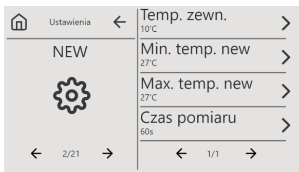
Rys. 23 Ekran ustawień nagrzewnicy elektrycznej wstępnej
