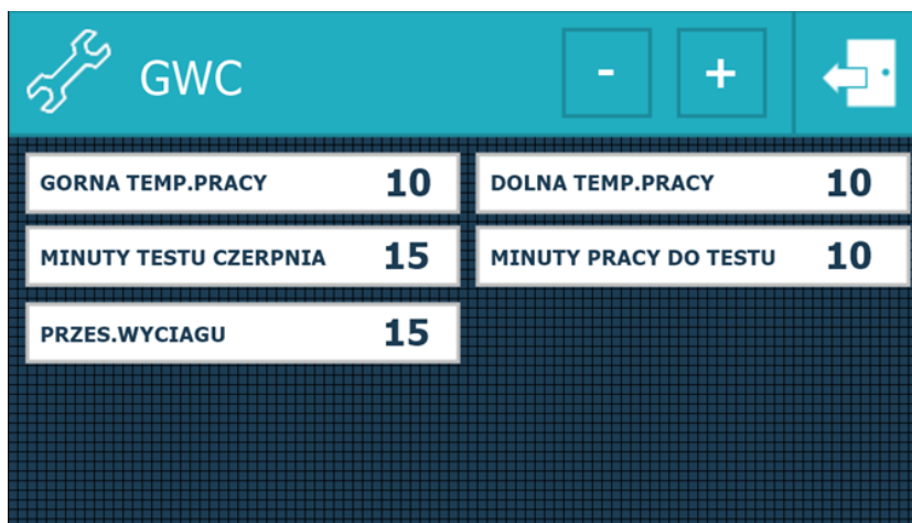
Rys. 28 Ekran ustawień parametrów gruntowego wymiennika ciepła
