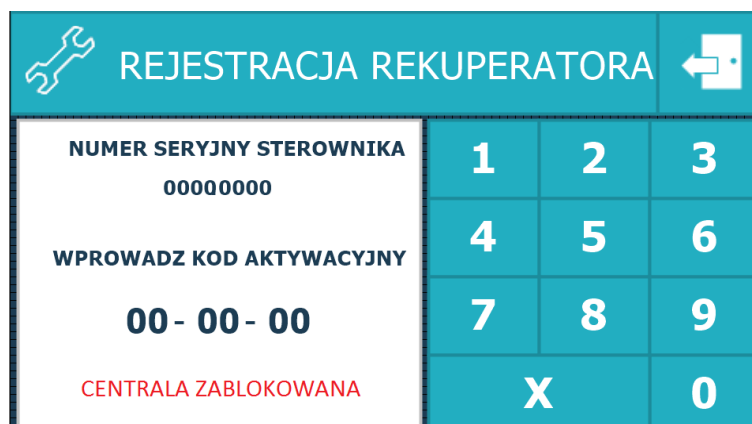
Rys. 10 Zakładka rejestracji rekuperatora – centrala zablockowana
