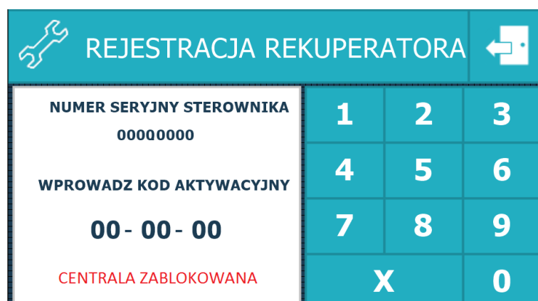
Rys. 12 Zakładka rejestracji rekuperatora – centrala zablokowana
